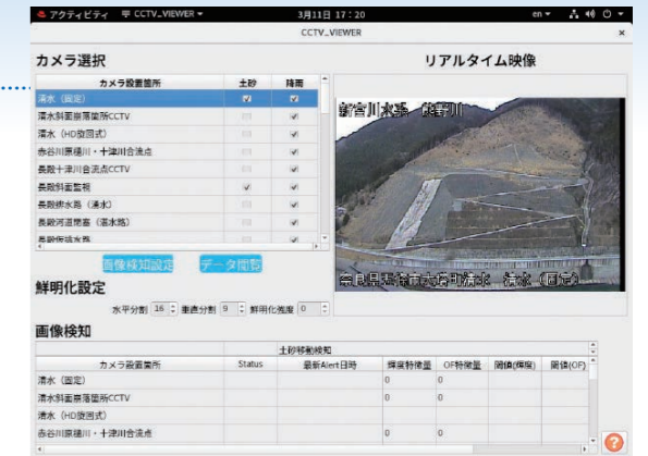
画像解析による土砂移動検知・監視映像の鮮明化システム
