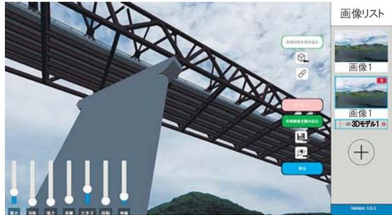
エイト日本技術開発（EJEC）は、全地球（360度）カメラで撮影した写真に3次元モデルを組み合わせてプレゼンテーションできる新システム「Eye-Con360」を開発した。点群データではなく360度写真を活用するため容量が小さく、発注者など関係者との意思決定がプロジェクトの初期段階から可能となり、BIM／CIMの進化を実現する。特に迅速な対応が求められる災害時に有効なコミュニケーションツールとしても期待される。2025年度からの本格運用を目指している。
