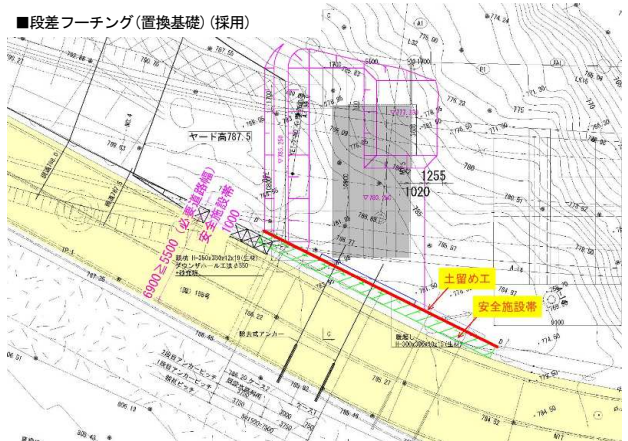
図-11 A1 橋台掘削範囲の検討
