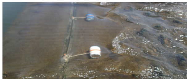
▲ カメラにはおもりをつけ、さらに流されないよう堰堤に固定
