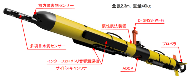
図-3 堆砂状況調査に導入した PMBS 搭載の AUV
