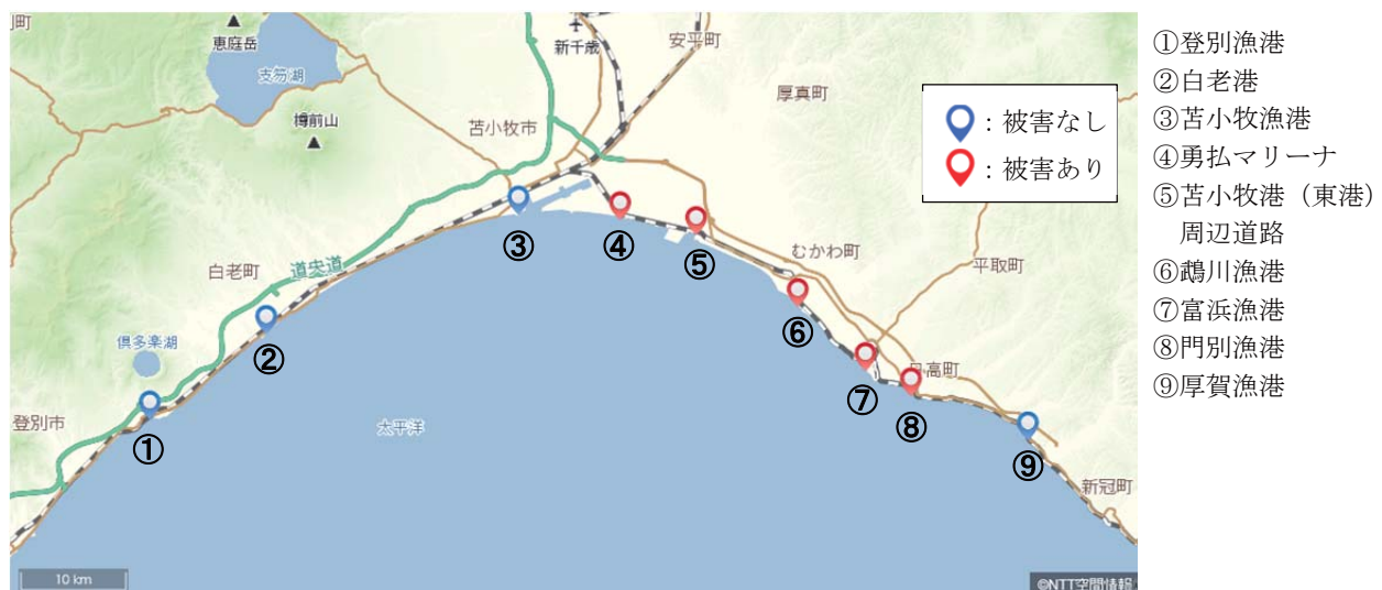
図 6.2.2 太平洋沿岸部に位置する漁港等の液状化被害分布
