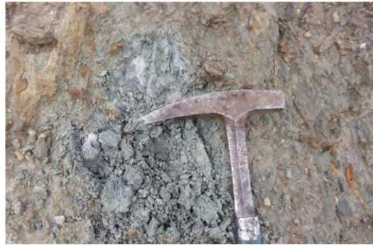
頭部付近の底面に露出する泥質片岩 不透水層を形成
