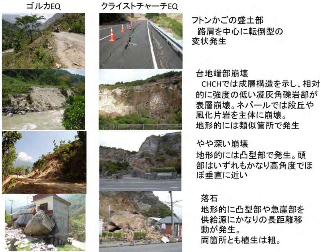
写真-4.36 ゴルカ地震とクライストチャーチ地震の被害形態の比較
